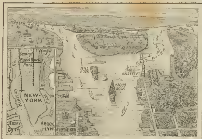
Fig. 2.—El paso del rio Este, denominado Puerta del Infierno, á vista de pájaro.—La línea de puntos al rededor de la Punta de Hallet indica la region de los escollos que se hizo volar en 1876.—Los puntos que rodean la Roca Flood señalan la region despejada por la explosion de 1885.—A la izquierda se ve el conjunto de Nueva York, mostrando la posicion geográfica de la Roca Flood.
